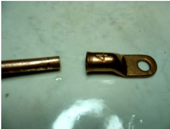
Tubing & lug before soldering
